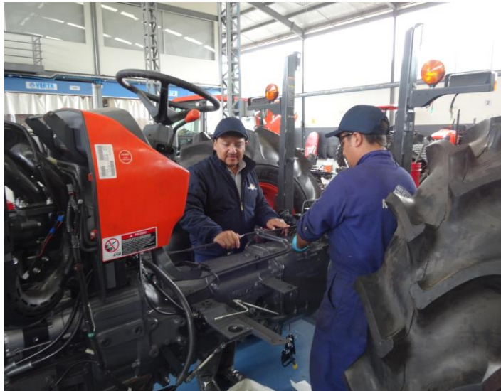
Fig. 17. Desarme tractor Kubota M9540. Fuente: Autores del documento, (2016).
