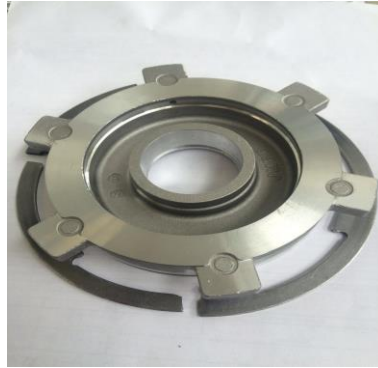
Fig. 15. Arandela Rota. Fuente: Autores, 2016.
