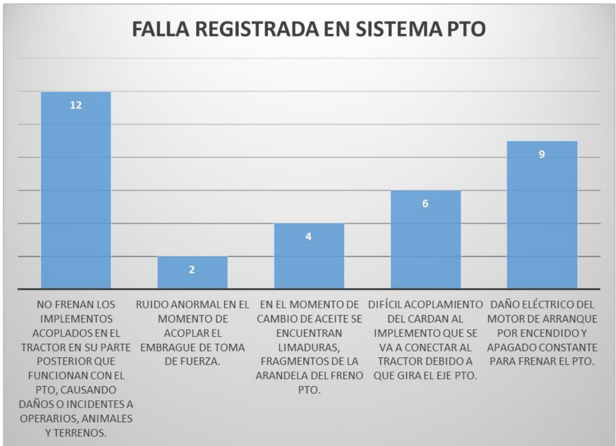
Fig. 14. Falla registrada en sistema PTO. Fuente: Autores del proyecto.
