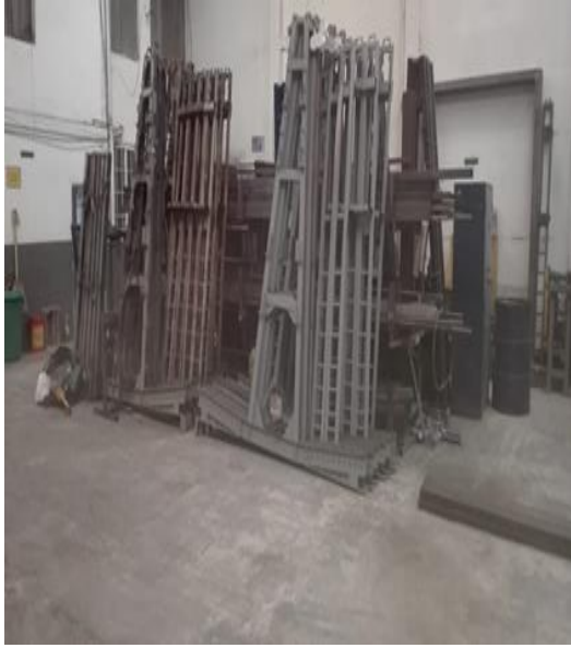
Foto No. 3 Atriles para cargue de vidrio en proceso de fabricación.
