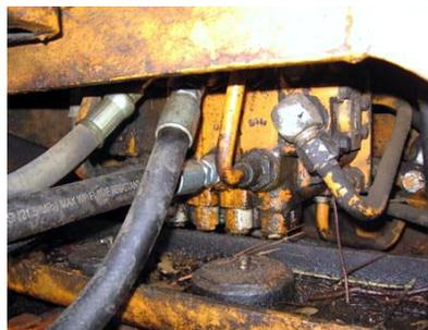
3. **Determinar si el componente hidráulico que está conectado a la manguera tiene una “carga móvil” o peso extra.** Si el aceite en el sistema que estás desconectando tiene presión todavía, puede expulsarse de forma forzosa cuando los empalmes que lo mantienen se aflojen, causando que el aceite sea descargado con presión. Antes de proceder, quita la presión de esos cilindros o componentes.
