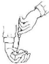
Sujeción incorrecta de una pieza a atornillar
