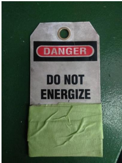
*Ilustración 5 Tarjeta de rotulación*
