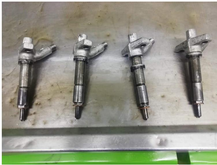
*Ilustración 7. Inyectores desmontados (autores, 2022)*
