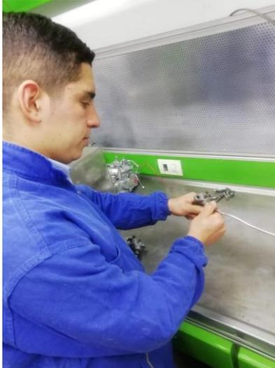
*Ilustración 8. Montaje del inyector en el probador (autores, 2022)*
