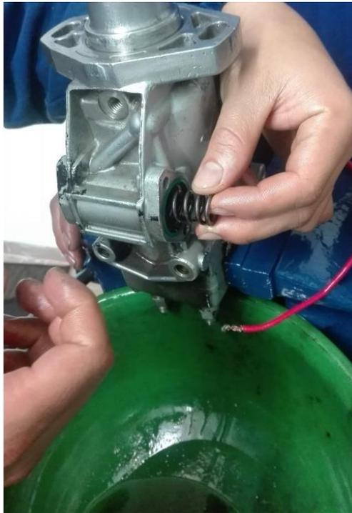
*Ilustración 40. Desensamble del avance (autores, 2022)*
