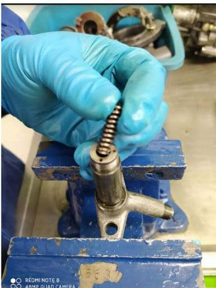
*Ilustración 17. Extracción del resorte de presión (autores, 2022)*
