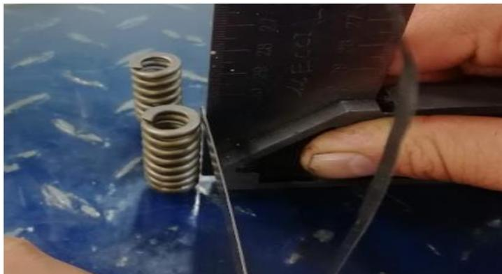
*Ilustración 56. Revisión de la rectitud del resorte (autores, 2022)*
