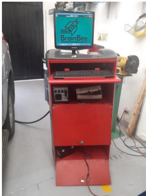
*Ilustración 58. Equipo opacímetro. (Pulido Segura, y otros, 2022)*
