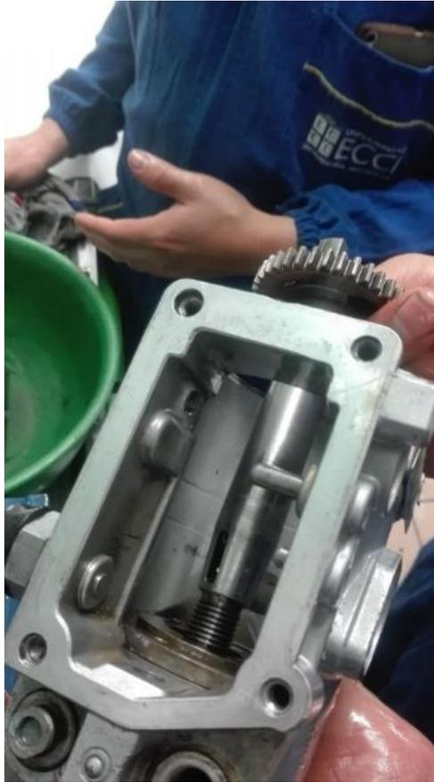
*Ilustración 39. Eje conductor (autores, 2022)*
