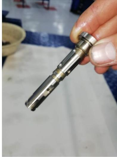
*Ilustración 43. Embolo del cabezal (autores, 2022)*
