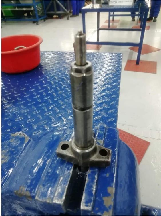
***Ilustración 15. Montaje para desensamblar los inyectores (autores, 2022)***
