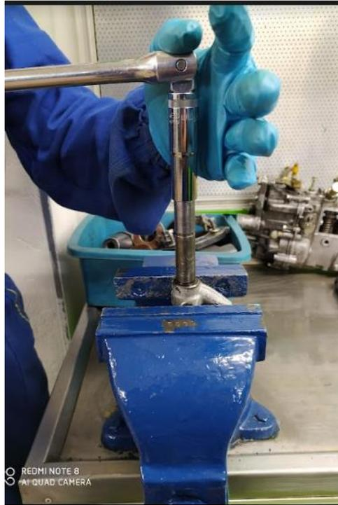
*Ilustración 16. Desajuste tuerca de retención (autores, 2022)*
