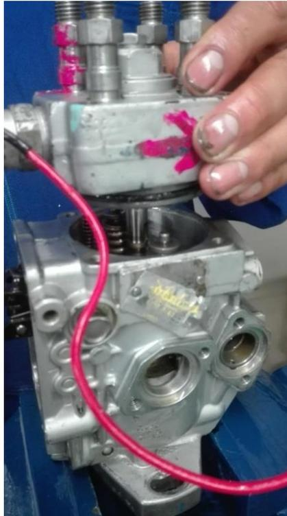
*Ilustración 33. Desensamble de la cabeza de distribución (autores, 2022)*
