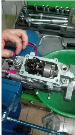
*Ilustración 31. Desconexión del cable del solenoide (autores, 2022)*
