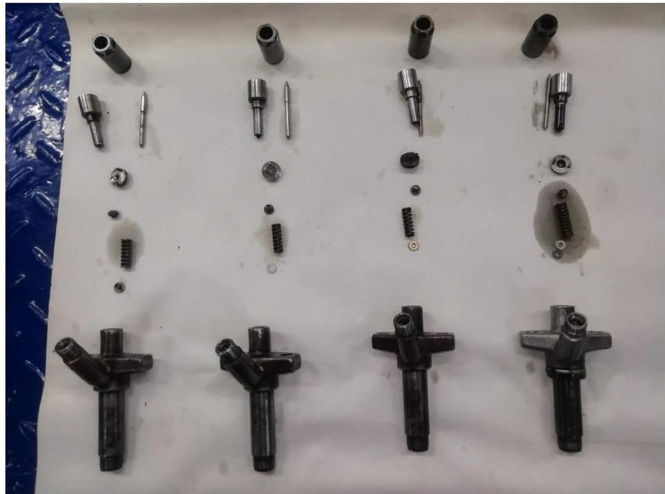
*Ilustración 19. Despiece inyectores (autores, 2022)*
