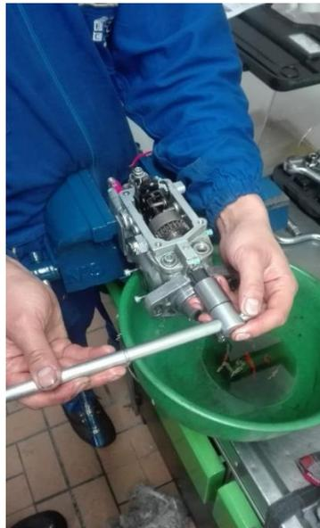
*Ilustración 32. Tuerca del eje de bloqueo (autores, 2022)*
