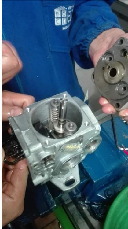
*Ilustración 34. Bomba sin cabezal (autores, 2022)*
