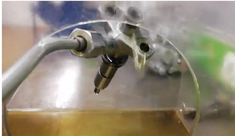
*Ilustración 13. Prueba de goteo de inyector (autores, 2022)*
