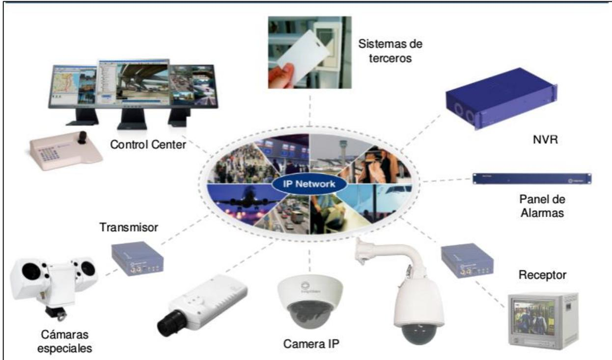
Figura 16. Topología de un sistema de CCTV IP
