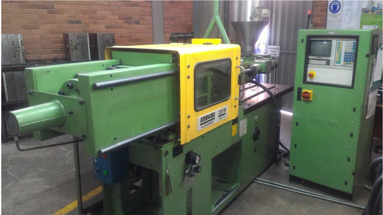
Figura 1 Equipo de Inyección
