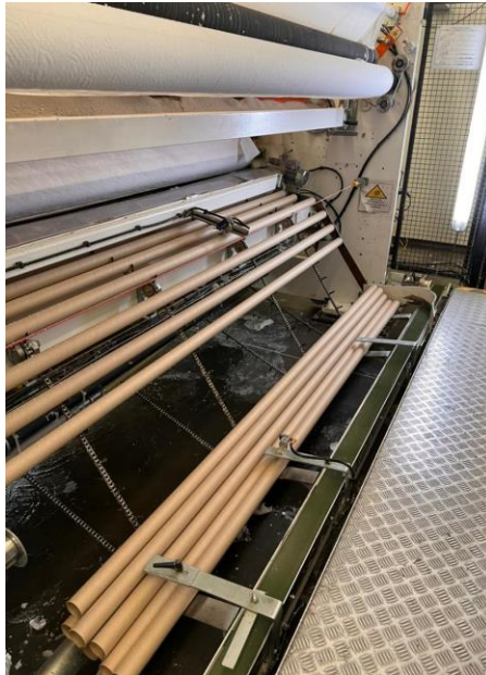
Figura 11 Tubeles antes del paso en la transferencia
