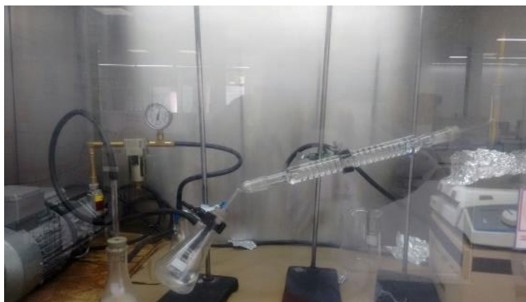
Ilustración 23. Montaje para remover monómeros residuales. Fuente este Estudio.
