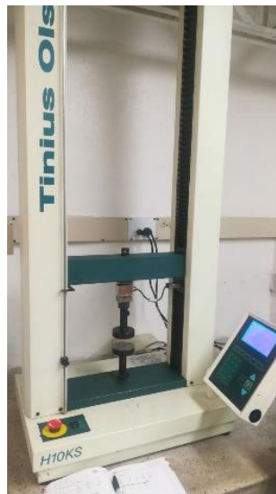
Ilustración 17. Máquina Universal, universidad ECCI.
