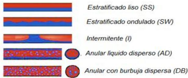
**Figura 5. Patrones de flujos bifásicos. Adaptado de Domitilo. [19]**
