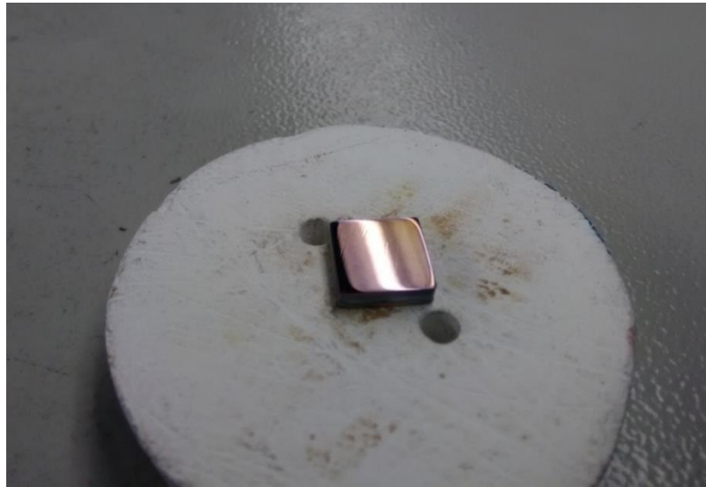
Figura 25. Sustrato de acero inoxidable 316L depositado por 15 min a 450°C.
