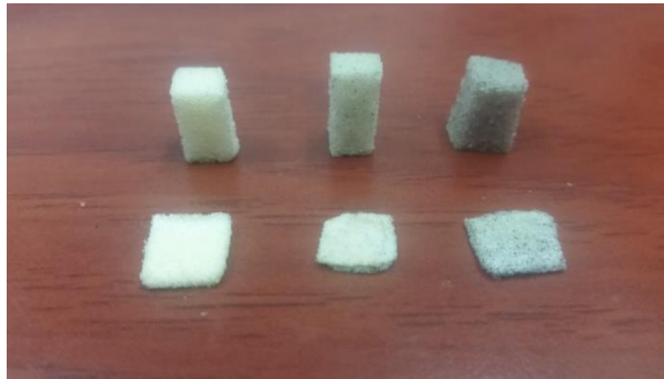
Figura 7. Probetas para ensayo de compresión
