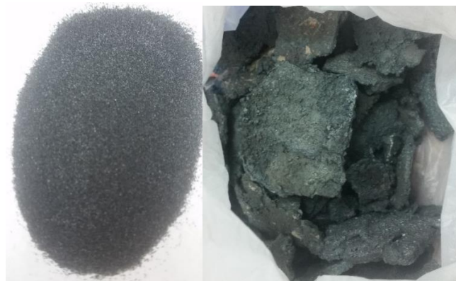
Figura 3. Escoria proveniente de acero SAE 1045 con y sin molienda
