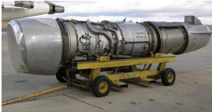
**Ilustración 29. Motor Pratt and Whitney JT8D-9A sobre su banco de transporte [20].**
