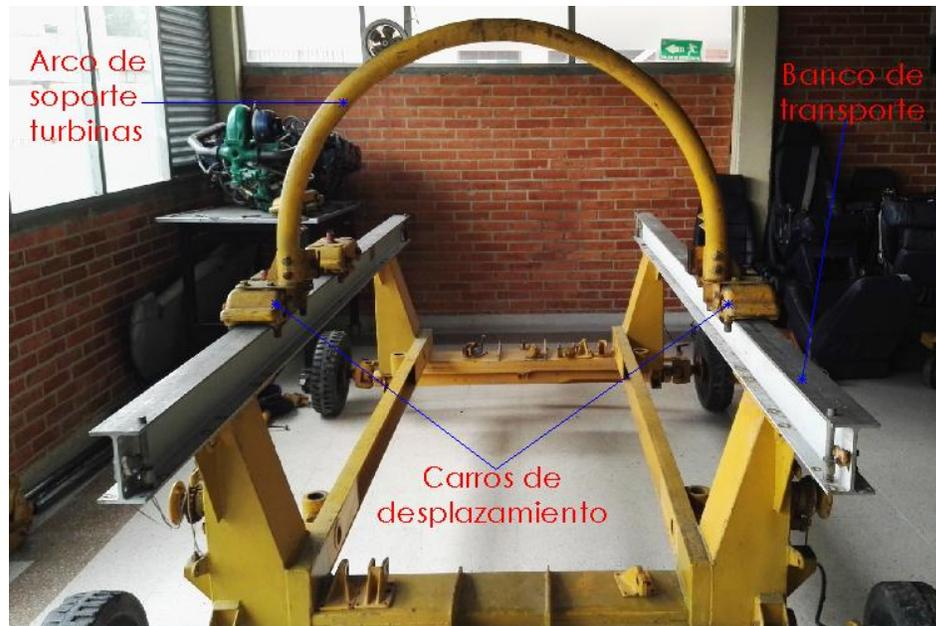
**Ilustración 28. Banco de transporte asignado por FAC para Turbinas PT6A-61.**
