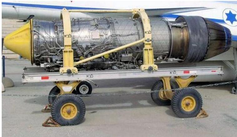
**Ilustración 30. Motor Pratt and Whitney PW1120 sobre banco de transporte [20].**
