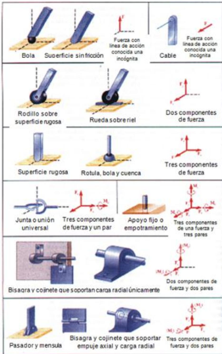
Ilustración 11. Tipos de reacciones en estructura tridimensional [9].
