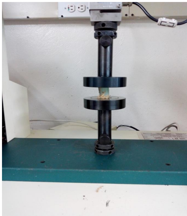
Figura 3-6 Prueba de compresión de material compuesto.
