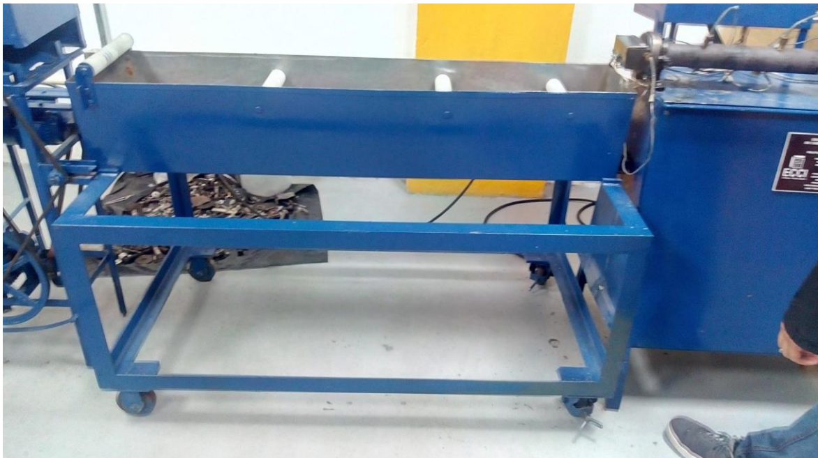
Figura 2-2 Peletizadora, tolva de refrigeración, U. ECCI.
