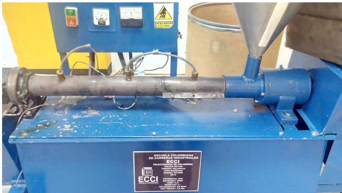
Figura 2-1 Peletizadora, camisa de extrusión, U. ECCI.
