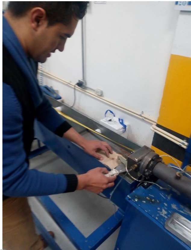
Figura 3-2 Impregnación de yute con polietileno de baja densidad.
