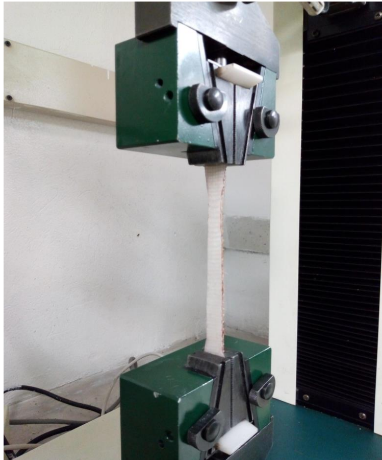
Figura 3-4 Probeta instalada en máquina universal de ensayos.
