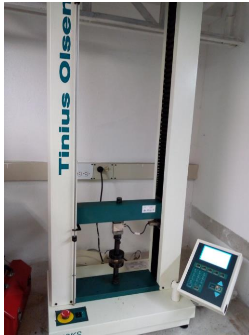
Figura 2-3 Máquina universal de ensayo TINIUS OLSEN H10KS.
