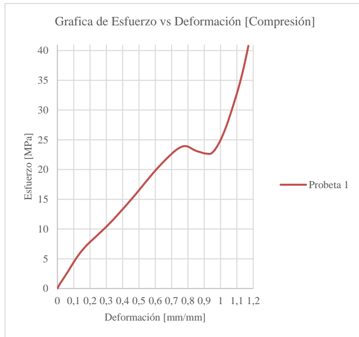
Figura 3-7 Gráfica esfuerzo vs deformación a compresión.
