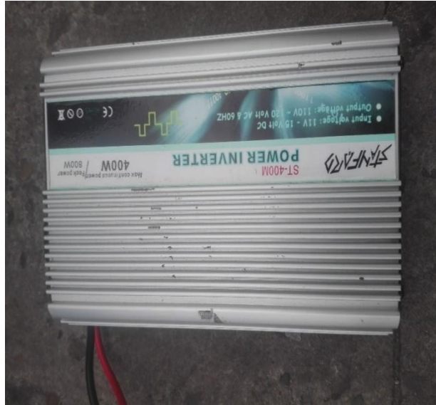
Ilustración 49. Inversor de voltaje
