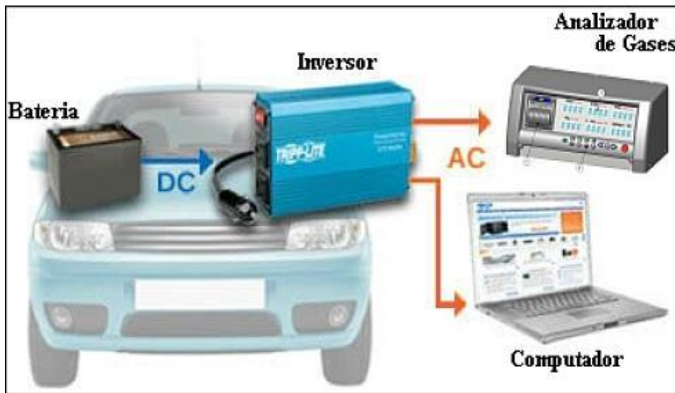
Ilustración 55. Esquema de conexión de aparatos al inversor de voltaje
