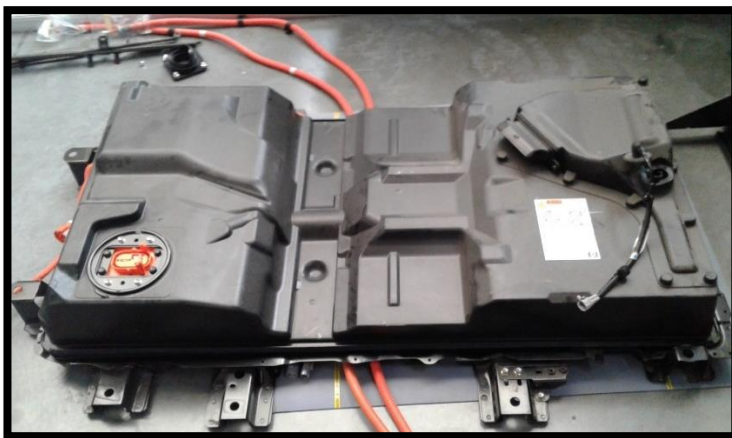
Paquete de baterías de alta tensión
