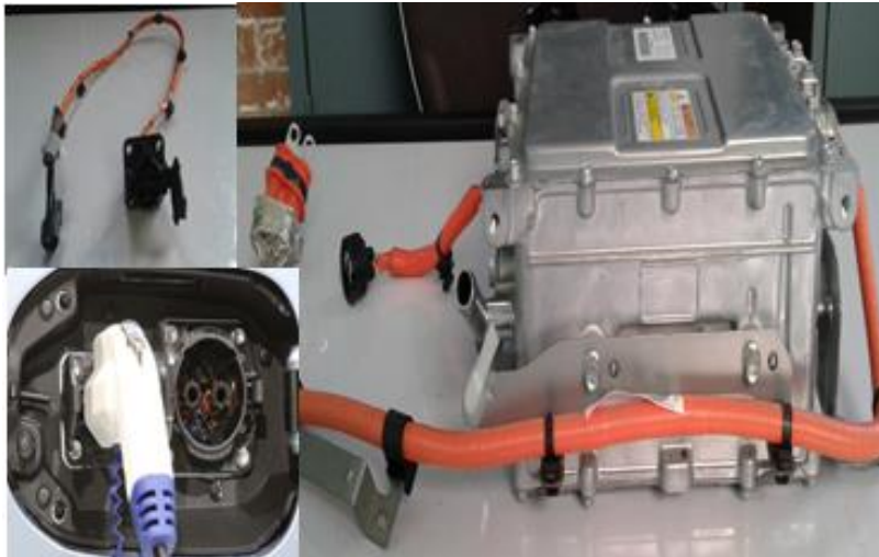
Convertidor y toma de carga
