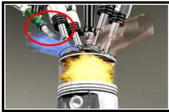
Ilustración 9 Inyección Indirecta ( http://www.revistaautocrash.com/wp-content/uploads/Edicio32/Electromecanico/explosion.jpg , s.f.)
