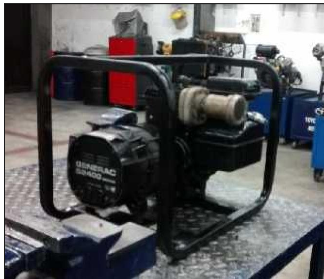
Imagen 1: Planta Generadora Generac S2400.
