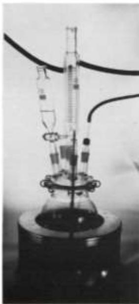
Imagen 4. . Equipo para la preparación de los copolímeros de ácido acrílico fuente tomada de (Crisp et al., 1980)
