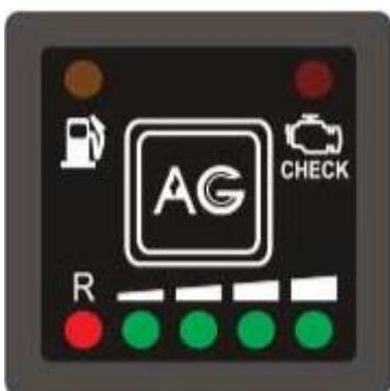
Figura 6: Botón de equipo GNV funcionamiento a gas
