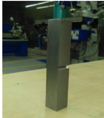
Figura # 26. Probeta ensayo Charpy terminada. Fuente (Autores, Probeta Ensayo Charpy, 2017)
