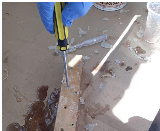
Imagen 13. Proceso de desmolde. Fuente: Autor.
