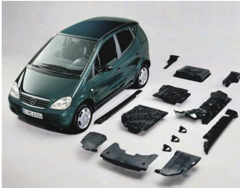
Imagen 1. Mercedes Benz A-Class, los componentes de la parte inferior de lino / polipropileno. (Koronis, 2013)
