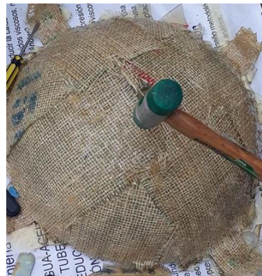
Imagen 11. Proceso de desmolde Fuente: Autor.
