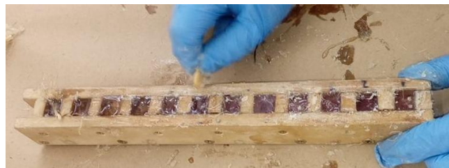
Imagen 12. Ubicación de la fibra en el molde para probetas. Fuente: Autor.
