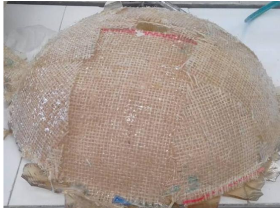
Imagen 9. Cubrimiento al molde con el material compuesto Fuente: Autor.
