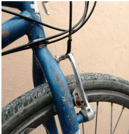
Ilustración 23 Desinstalación del freno V brake. (De los autores)
