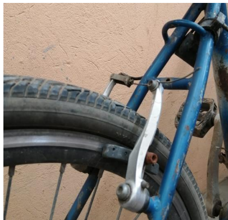
Ilustración 23 Desinstalación del freno V brake. (De los autores)
