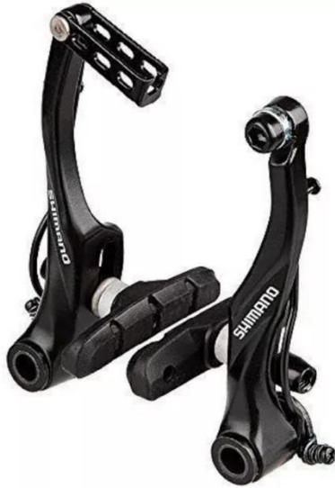
Ilustración 19 Sistema de freno V-brake. (Pedal moto)
