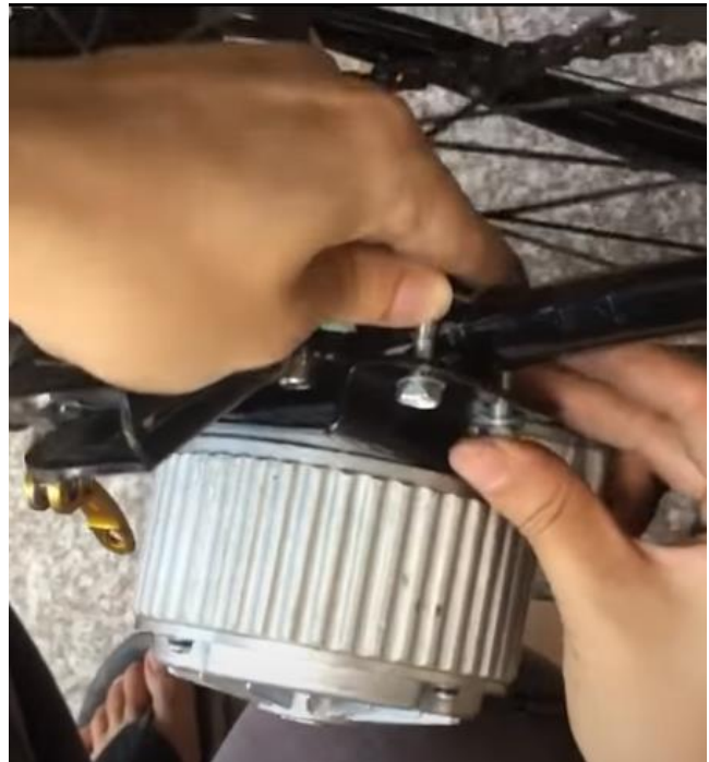
Ilustración 13 Instalación del motor al marco de la bicicleta. (De los autores).
