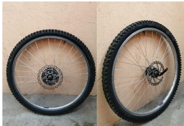
Ilustración 27 Adaptación de los rines para el sistema de frenado de disco (De los autores)
