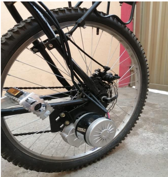
Ilustración 33 Autoría propia simulación de las partes del motor y la rueda.
