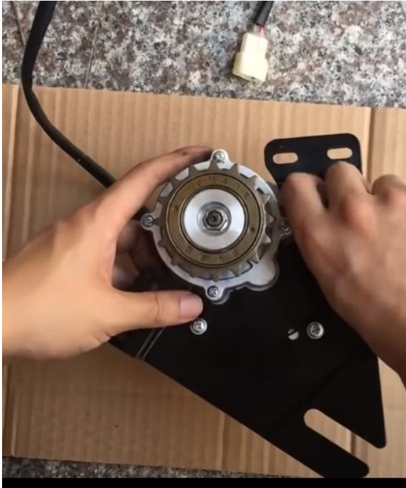
Ilustración 12 Instalación del motor con ayuda de un montaje. (De los autores)
