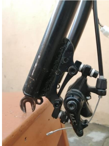
Ilustración 26 Instalación de las mordazas ya rediseñadas. (De los autores)
