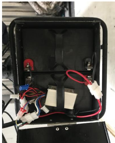
Ilustración 17 Instalación de conectores al banco de baterías ya ensamblado en la bicicleta. (De los autores)
