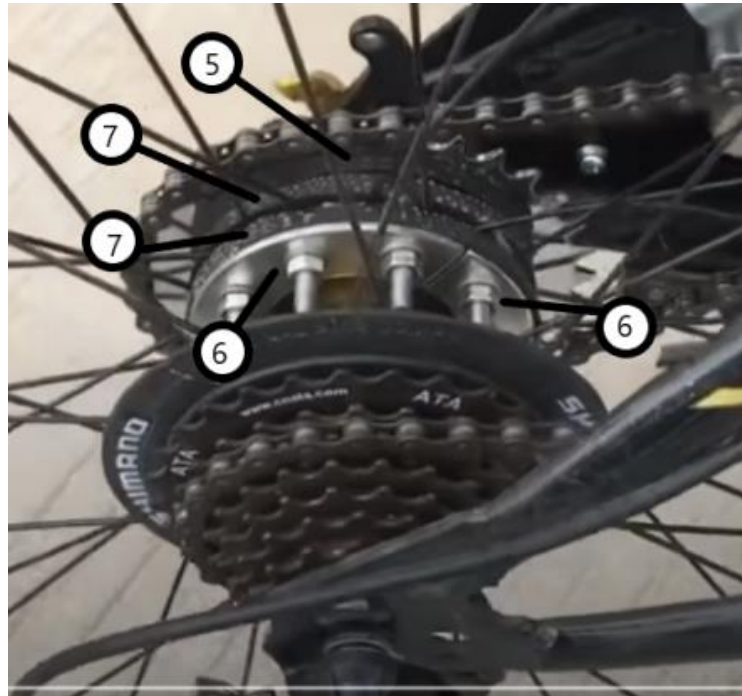
Ilustración 10 Verificación que los radios no presenten deformaciones. (De los autores)
