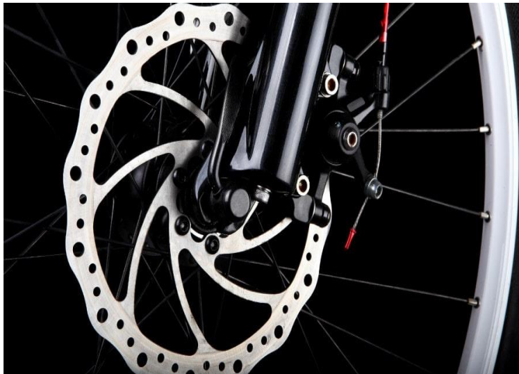
Ilustración 21 Sistema de freno de disco por guaya. (Pedal moto)
