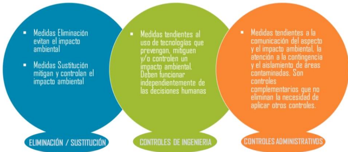
Diagrama N° 9 Medidas de eliminación/sustitución, controles de ingeniería y controles administrativos.
