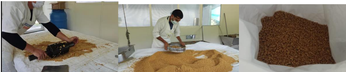
Imagen N°11 Proceso de tamizado y triturado
