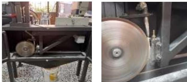
**Figura.3** Resistencia a la abrasión.
