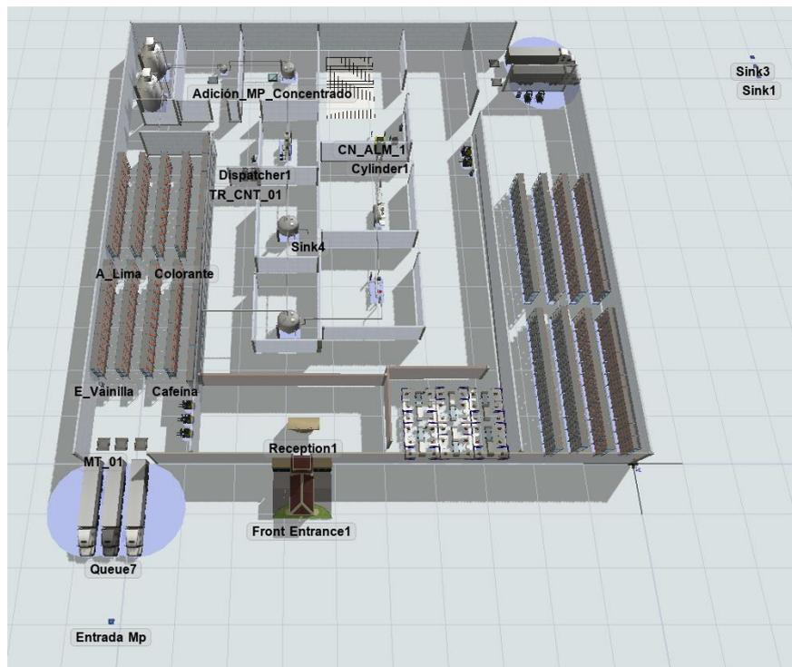
Figura 7: Diseño de la planta de fabricación de gaseosas. Fuente: Software FlexSim.
