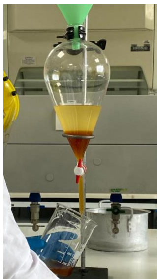
Figura 9. Montaje decantación 2 con material de vidrio.
