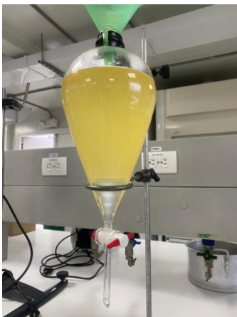
Figura 11. Montaje de lavados con material de vidrio.
