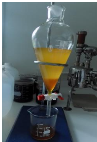
Figura 7. Montaje decantación 1 con material de vidrio.
