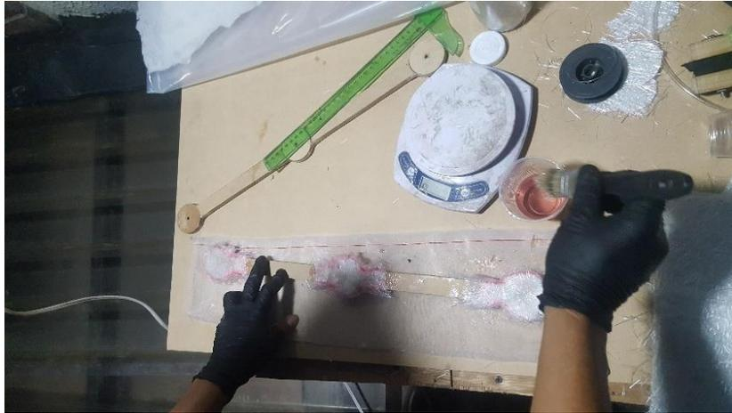
*Ilustración 22. Imprimación de fibra*
