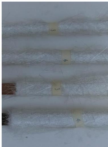
*Ilustración 11. Fabricación de probetas resina.*
