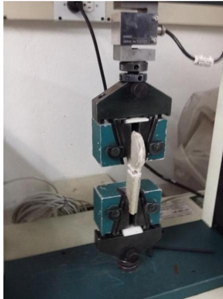
*Ilustración 12. Prueba de tensión maquina universal UNIECCI*
