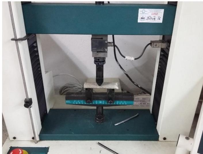
*Ilustración 15. Prueba de flexión maquina universal UNIECCI*
