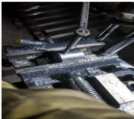
*Ilustración 31. Perforado de buje de sujeción carro principal*
