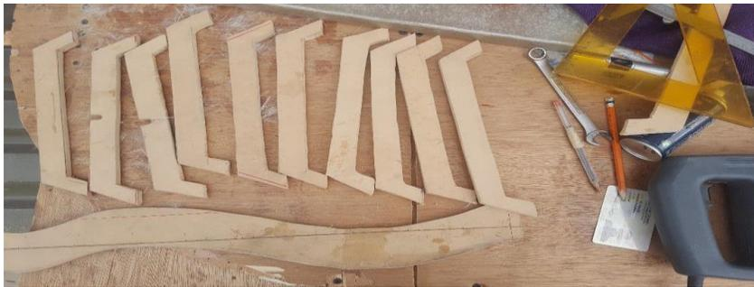
*Ilustración 24. Núcleo soporte medular cortado*
