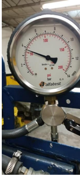
Figura 4- 7: Manómetro de presión de combustible-Alfatest utilizado para comprobar la presión de salida de combustible hacia los inyectores.
