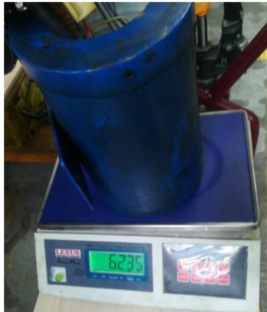
Figura 4- 19: Pesaje inicial del depósito de gasolina
