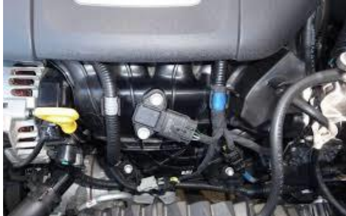
Figura 2- 5: Sensor de presión absoluta del múltiple de 3 cables fuente//. (Codigos DTC , 2020).
