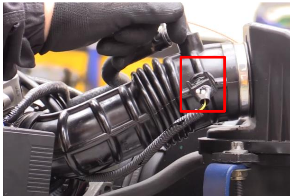
Figura 2- 7: Sensor IAT ubicado en el inicio de la admisión del motor Chevrolet aveo fuente//. (Universidad ECCI, 2020).
