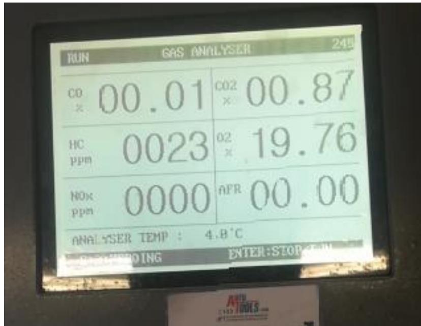
Figura 5-3: Instante máximo de emisiones encontrado para la mezcla E85 durante la prueba crucero fuente// autor
