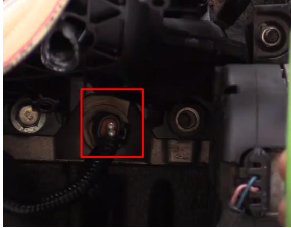
Figura 2- 8: Sensor ECT ubicado en la parte central del bloque motor Chevrolet Aveo 1.6 fuente//. (Universidad ECCI, 2020)
