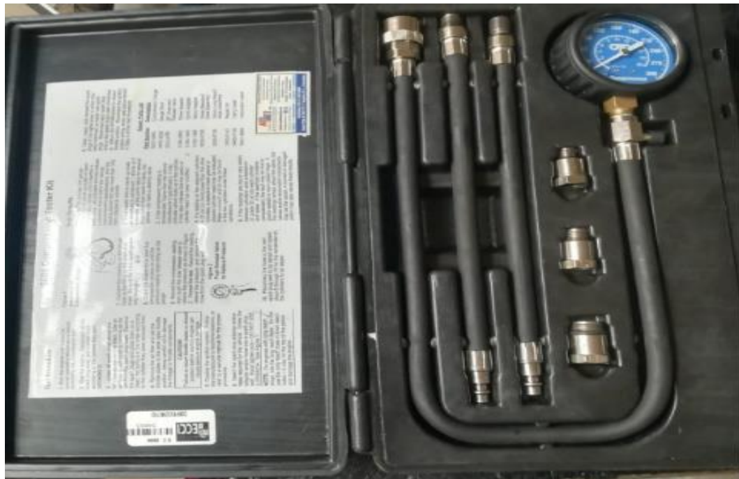
Figura 4- 1: kit de testeo de compresión 5606 junto a 3 acoples y 3 mangueras adaptables de prueba.
