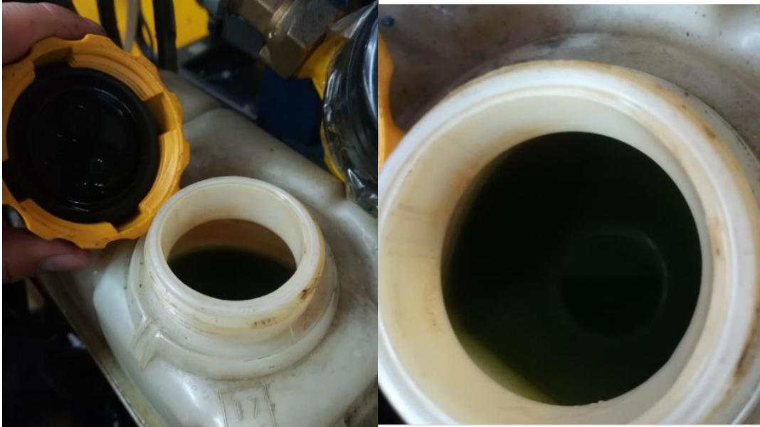
Figura 4- 13: Deposito de refrigerante del motor Chevrolet Aveo 1.6L
