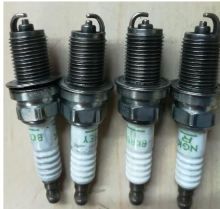
Figura 4- 9: Juego de bujías standard de 1 electrodo de marca NGK para el motor Chevrolet Aveo.
