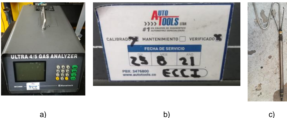
Figura 4- 15: a) Analizador HANATECH-2400 usado en la metodología experimental de este proyecto b) Fecha de calibración y verificación el 23 de agosto de 2021 perteneciente a la Universidad ECCI c) sonda de pruebas utilizada en el experimento.
