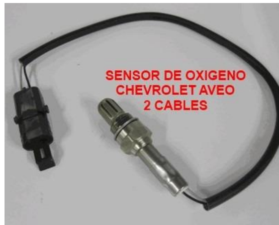
Figura 2-9: Sensor de oxígeno usado en el Chevrolet Aveo 1.6 de dos cables (Aveo, 2008)
