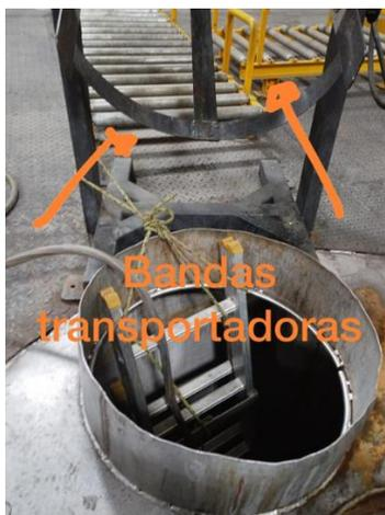
*Nota:* El gráfico representa la finalización de bandas transportadoras y a su llegada al vaciador mecánico.
