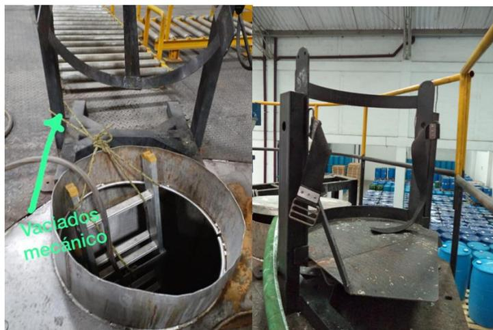
*Nota:* El gráfico representa el vaciador mecánico en la boca del reactor.
