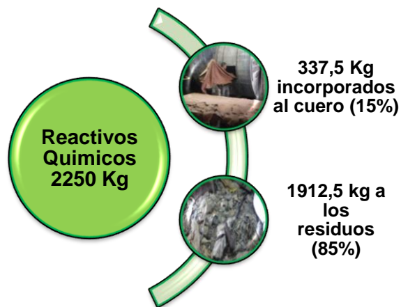
Figura 15. Porcentaje de reactivos químicos retenidos en el cuero (por 5000 Kg) Fuente: Guía Técnica de Producción Más Limpia para Curtiembres.
