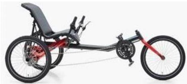
Fig. 18 Triciclo trike bike tipo Delta. Obtenido en: [www.bentrideronline.com](http://www.bentrideronline.com), s.f. Julio 2015
