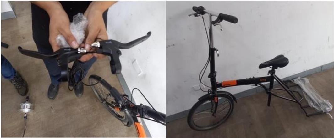
También se realizó la instalación del motor eléctrico en la rueda delantera, figura 30. esta se debió transformar en la longitud de sus radios, también se decidió establecer la tracción eléctrica en la rueda delantera por motivos de cableado del motor y mejor distribución de la tracción en un solo punto en vez de dos como están apoyadas las ruedas traseras.
