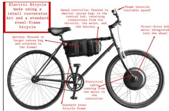
Fig. 7 Bicicletas de tracción humana convertidas a tracción eléctrica asistida. Obtenido de: <https://brainly.lat/tarea/27216685>
