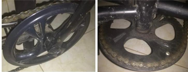
En la figura 27 se puede evidenciar el nuevo plato que se implementó. En la figura 28 se encuentra el nuevo piñón de transmisión trasera montado en los ejes traseros que son partido en 2 partes iguales para que disminuya la velocidad de cada una de las ruedas en los momentos de dar una curva en cualquier sentido.
