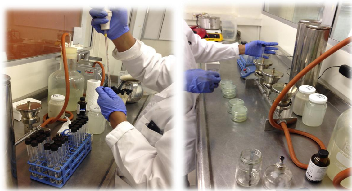
Fotografía 10. Análisis de Coliformes Totales y Escherichia coli
