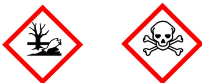
Figura 9. Etiquetas del sistema globalmente armonizado para residuos peligrosos
