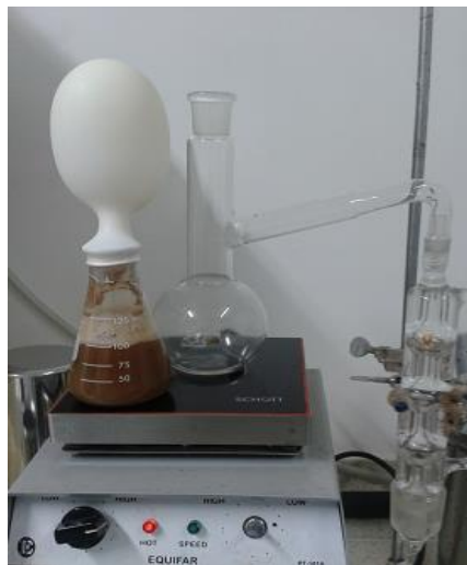
Ilustración 12. Preparación de la muestra con residuos de gaseosa para la destilación Simple.
