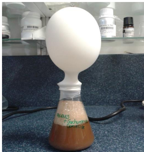
Ilustración 8. Fermentación de Residuos de Gaseosa después de 24 horas.
