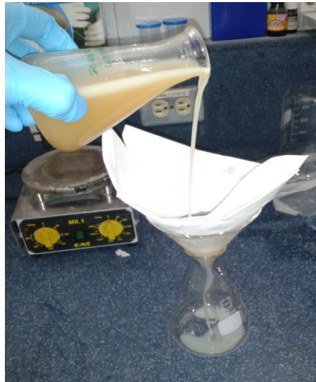
Ilustración 11. Filtración de la Muestra para el Proceso de Destilación.
