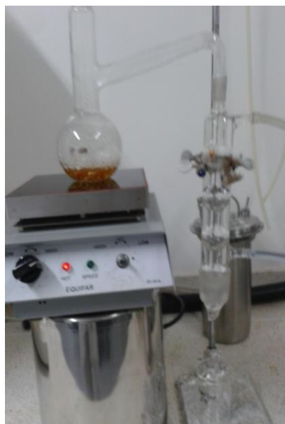
Ilustración 13. Destilación de la muestra con residuos de Gaseosa.
