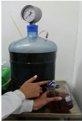
Ilustración 12. Recolección de la muestra, para el proceso de destilación.
