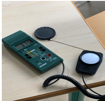
Imagen 2. Luxómetro digital modelo 401025 de Extech.
