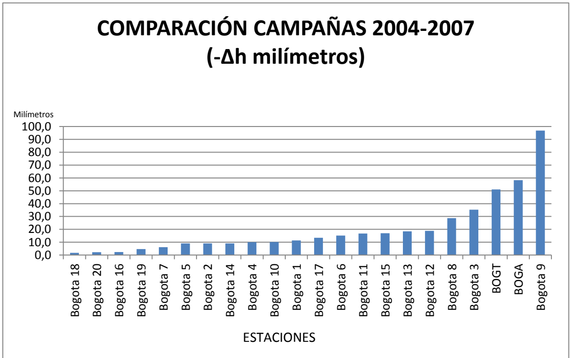
Figura 22. Puntos Geodésicos con hundimientos de suelo detectados 2004-2007.
