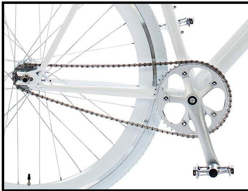
*Ilustración 27: Transmisión por cadena*
