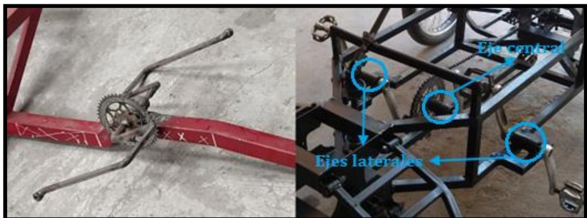
*Ilustración 49: Sistema de tracción antes y después*
