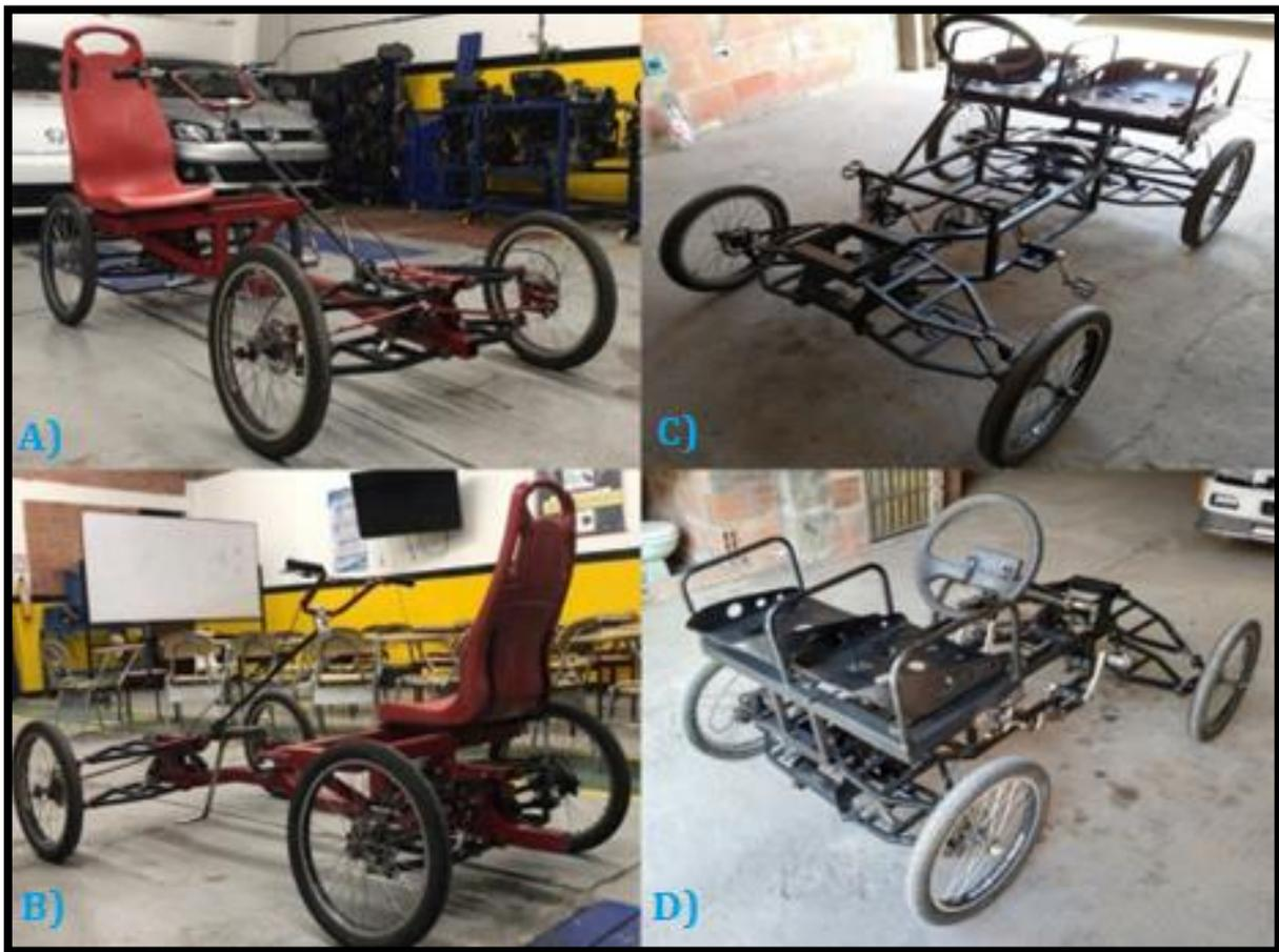
*Ilustración 44: Diseño previo vs Rediseño*
