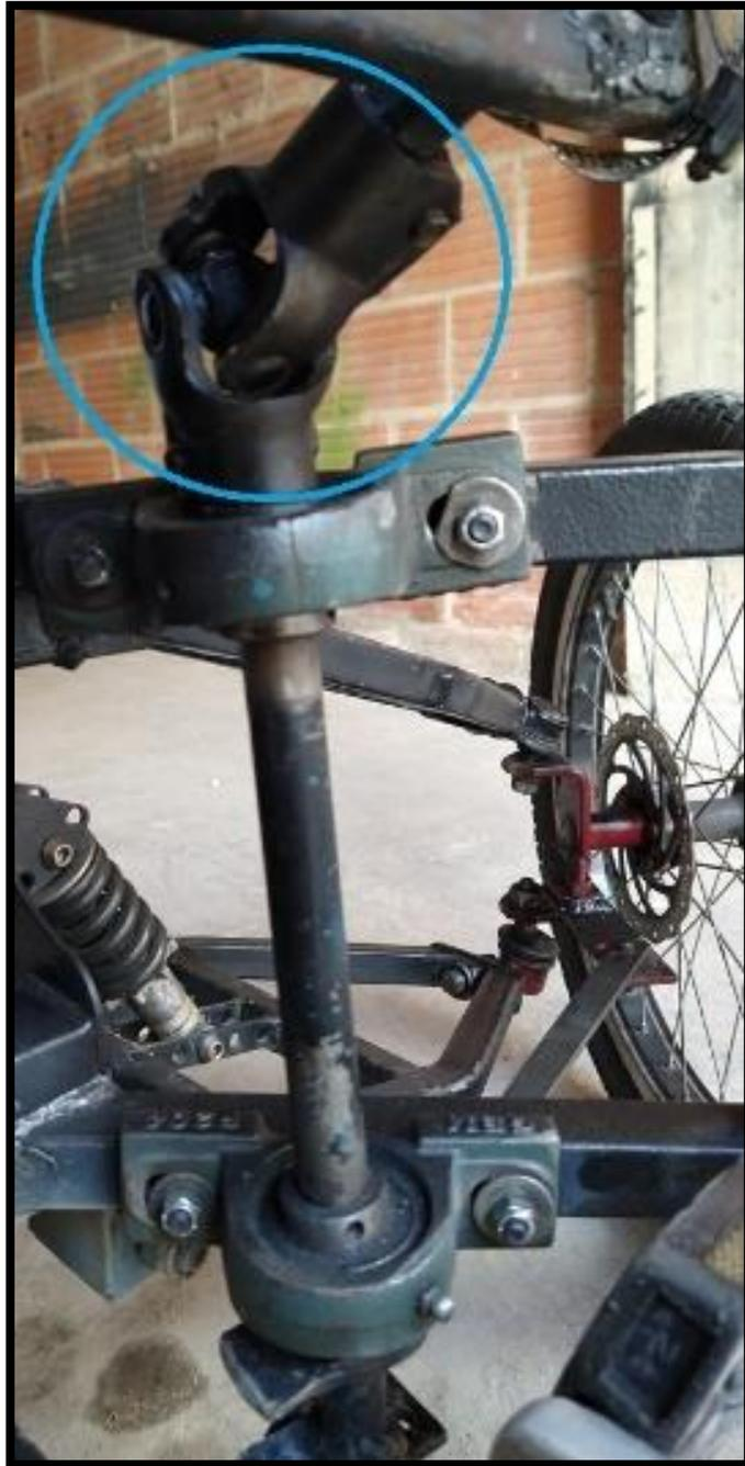
*Ilustración 47: Eje que conecta con la columna de dirección*
