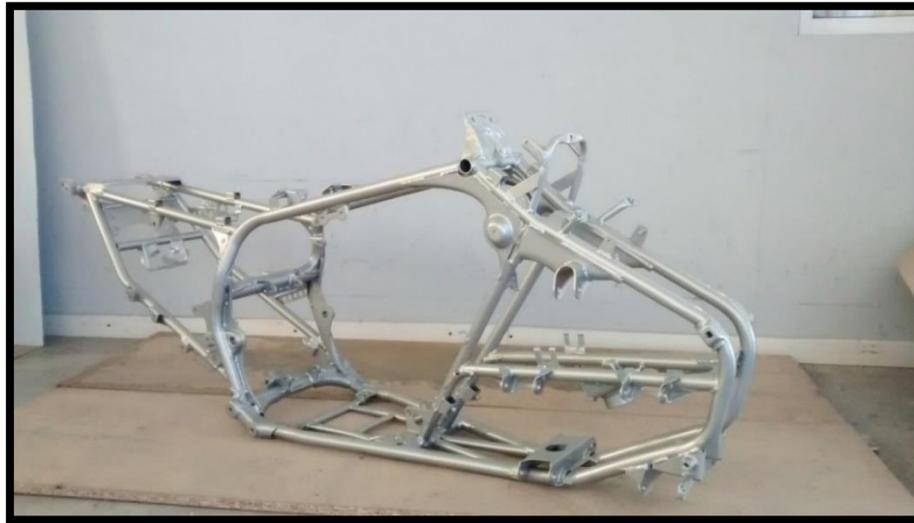
*Ilustración 18: Chasis de un cuatriciclo*
