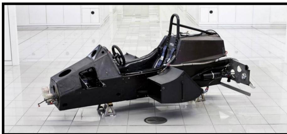
*Ilustración 20: Chasis monocasco*
