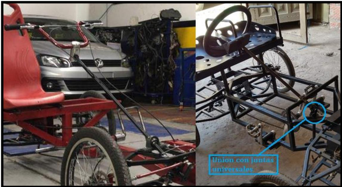
*Ilustración 46: Columna de dirección antes y después*
