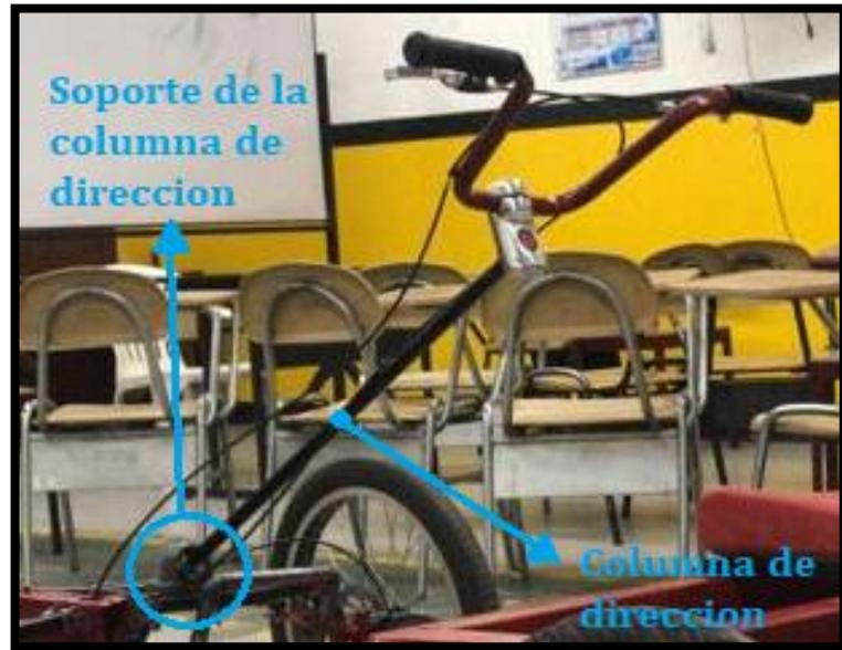
**Ilustración 9:** Columna de dirección
