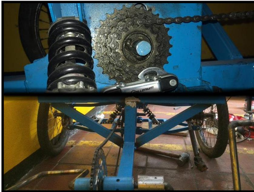
*Ilustración 11: Sistema de transmisión*
