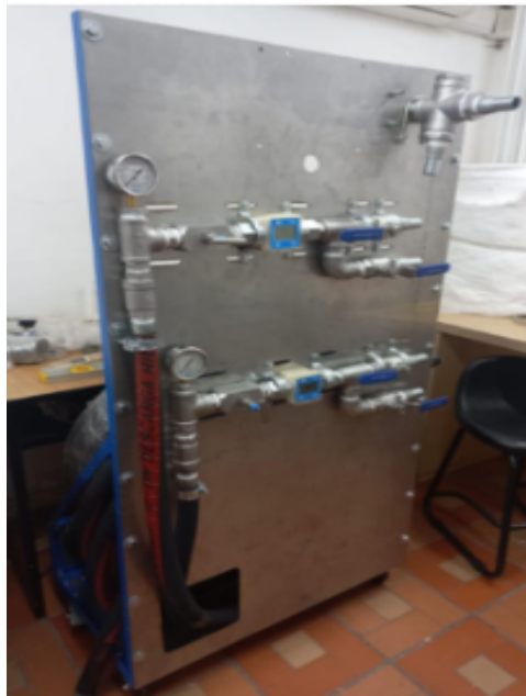
Figura 8. Construcción del mezclador estático, Fuente Propia.
