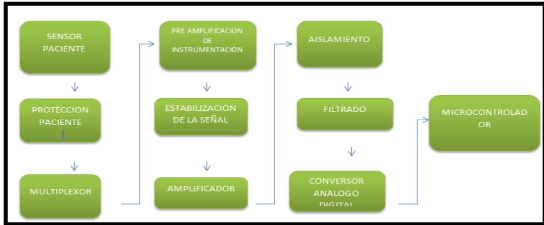
Figura 19 Diagrama de bloques diseño electrocardiógrafo.
