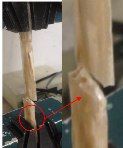
Figura 54: Ruptura Probeta de resina poliuretano compuesta con fibras de yuca. Fuente: Autor
