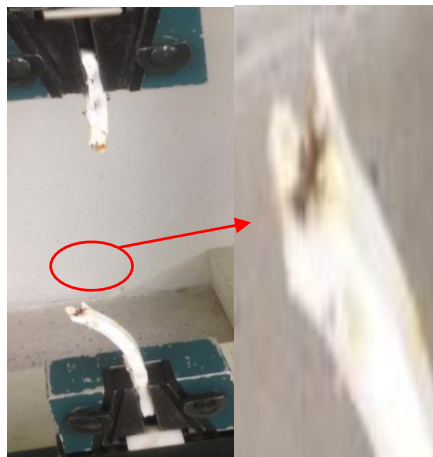
Figura 75: Ruptura Probeta de silicona compuesta con Cascaron de achote, al ejercer tensión máxima. Fuente: Autor.
