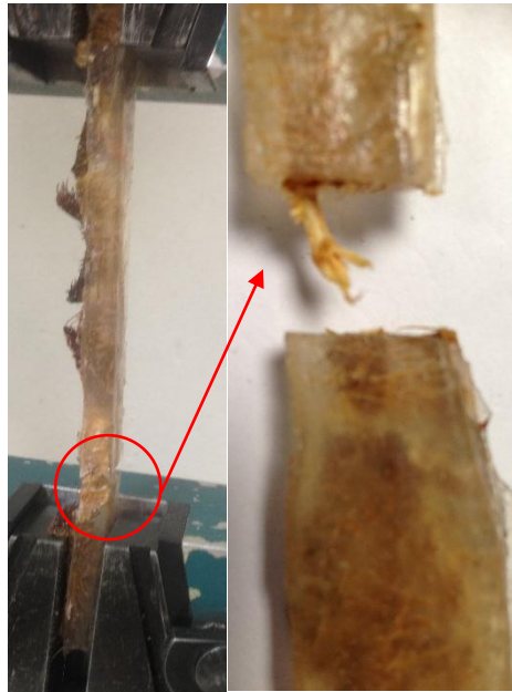
Figura 69: Ruptura Probeta de resina de poliéster compuesta con cascaron de achiote, al ejercer tensión máxima. Fuente: Autor.
