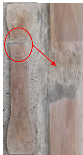
Figura 63: Ruptura Probeta de resina acrílica compuesta con fibras de pelo de maíz. Fuente: Autor.
