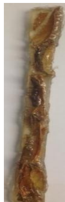
Figura 23: Probeta de resina de poliéster compuesta con Cascaron de achiote. Fuente: Autor.
