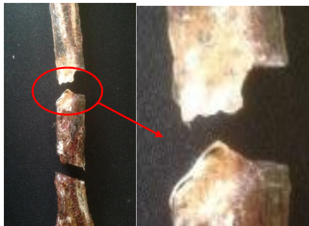
Figura 42: Ruptura Probeta de resina de poliuretano compuesta con cascara de achote, al ejercer tensión máxima. Fuente: Autor.
