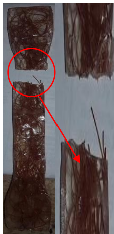
Figura 51: Ruptura Probeta de resina de poliuretano compuesta con pelo de mazorca, al ejercer tensión máxima. Fuente: Autor.
