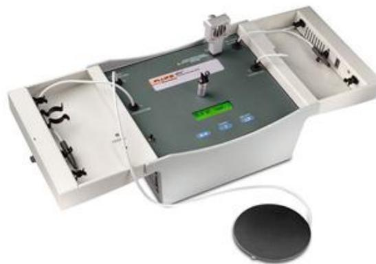
*ILUSTRACIÓN 2. ANALIZADOR DE INCUBADORA INCU*
