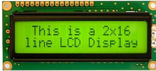
ILUSTRACIÓN 6.LCD 2X16
