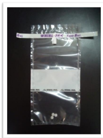
Figura 6: Bolsa Whirl-Park para toma de muestra microbiológicas, suministrada por el laboratorio NULAB LTDA.
