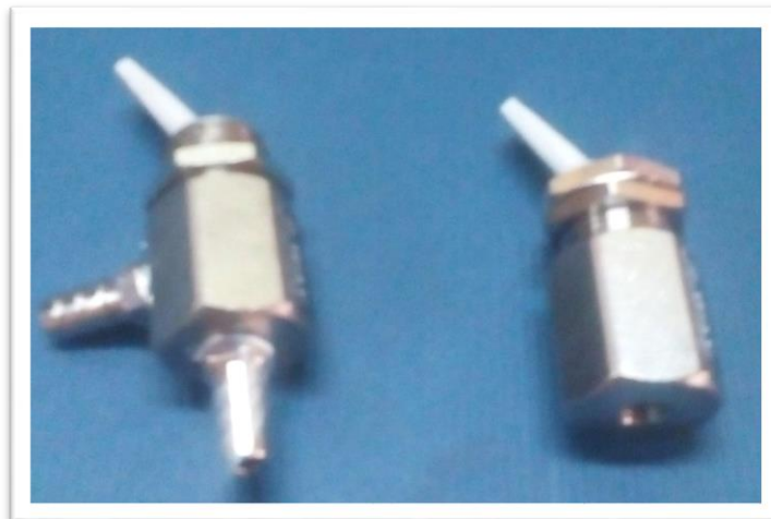
Figura 18: Válvulas on/off y válvula de dos vías Fuente: Autor
