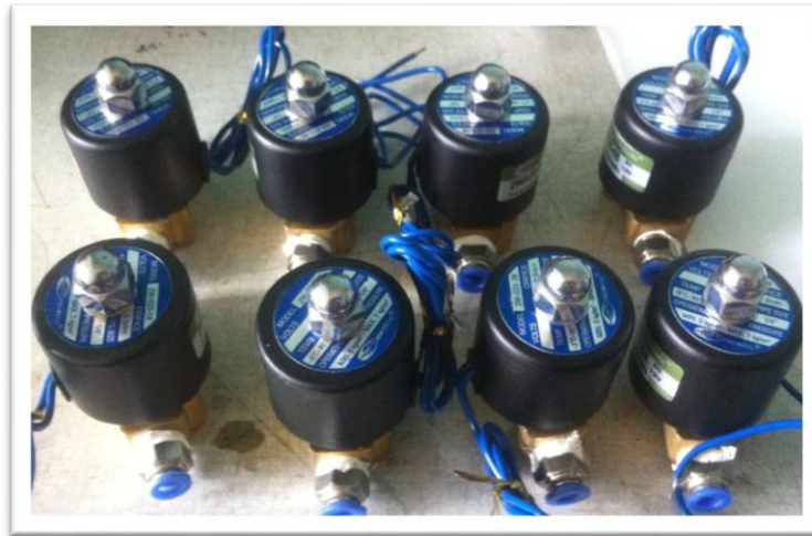
Figura 12: Electroválvula a 12 V DC Fuente: Autor
