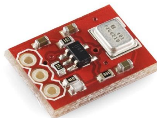
Ilustración 17. Tarjeta INMP401 desarrollada por Sparkfun ®
