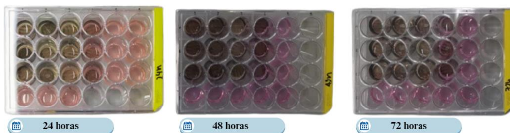
Figura 10. Microplacas para evaluar la citotoxicidad del recubrimiento a las 24, 48 y 72 horas. Recubrimientos inmersos en el medio de cultivo durante el proceso de evaluación.
