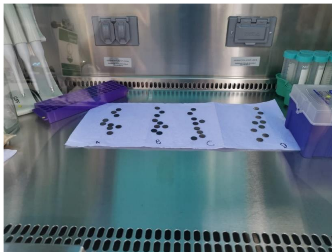
Figura 8. Esterilización de los recubrimientos con luz ultravioleta en cabina de cultivo.
