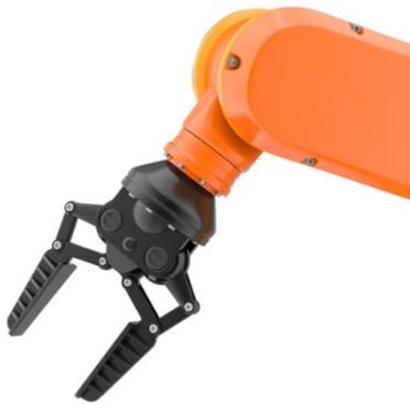
Figura 6. Gripper tipo pinza de ajuste flexible.
