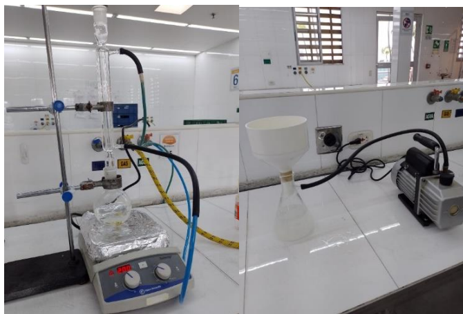
Ilustración 23: Montajes prueba de análisis de fibra cruda
