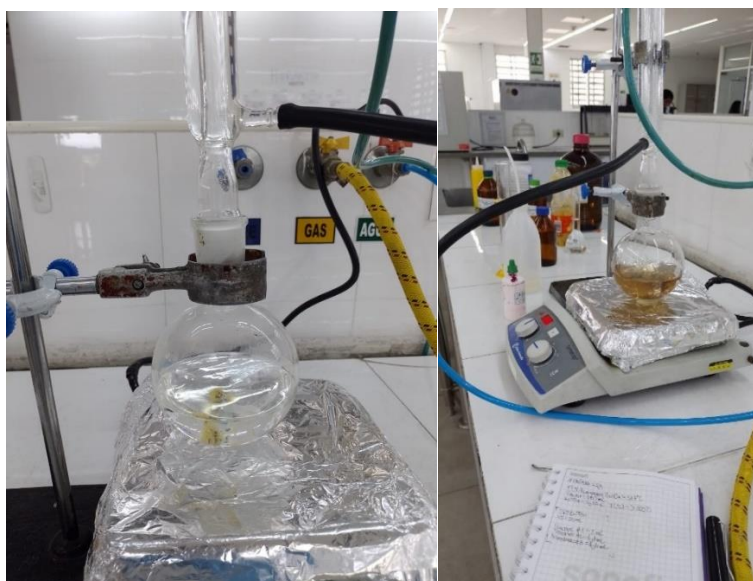
Ilustración 24: Desarrollo prueba de análisis de fibra cruda
