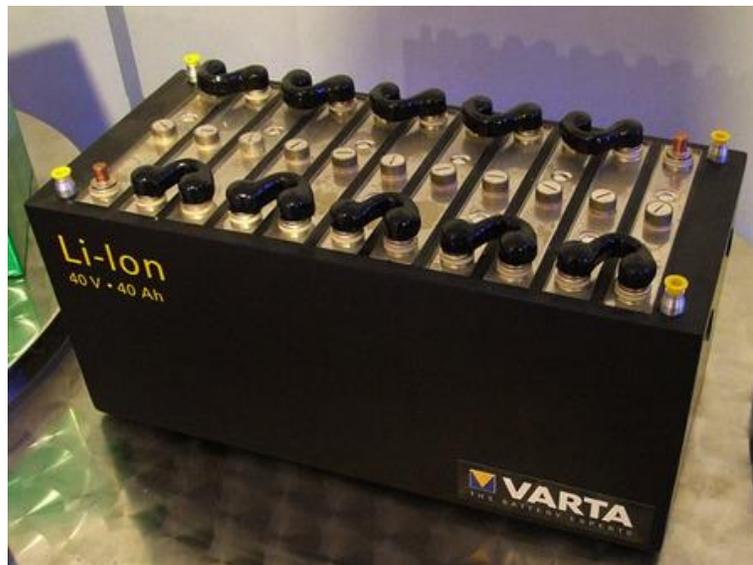
*Ilustración 50. Celdas de una batería. Tomado de Motor pasión.*
