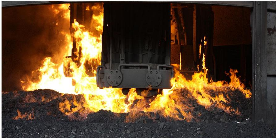
*Ilustración 21. Obtención de manganeso por calcinación. Tomado de comunidadesautlan.com*
