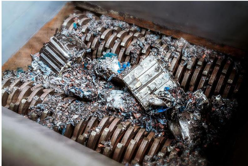
*Ilustración 59. Residuos baterías de alto voltaje (HV). Tomado de El español*
