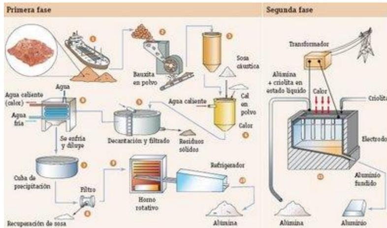
Ilustración 27. Extracción de aluminio. Tomado de Blogspot.com
