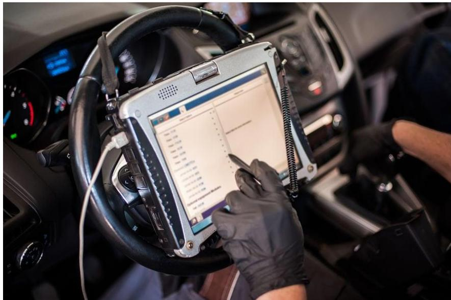
*Ilustración 57. Determinación de SOC con scanner. Tomado de Ruta 401*
