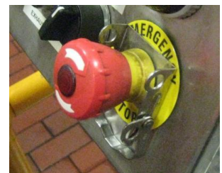
Ilustración 24. Parada de emergencia. Controles no ofrecen 0 acceso. Fuente. Nestlé (2015) oficina central Colombia
