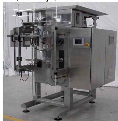
Ilustración 1. Llenadora vertical Frabrima 6. Fuente. Nestlé (2015) oficina central Colombia
