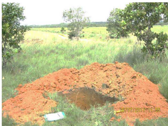
Fotografía 5. Calicata en campo.
